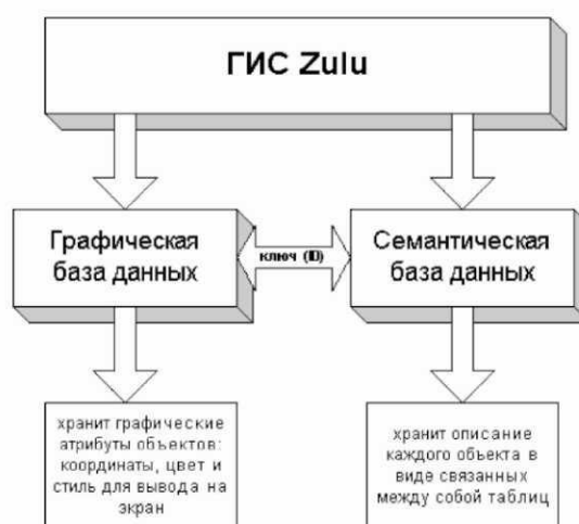
Рисунок 9.1. Структурная схема представления информации в системе Zulu
